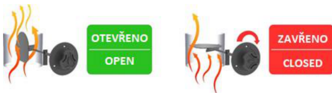
Schéma III-2.2 – Ovládání klapky odvodu spalin
